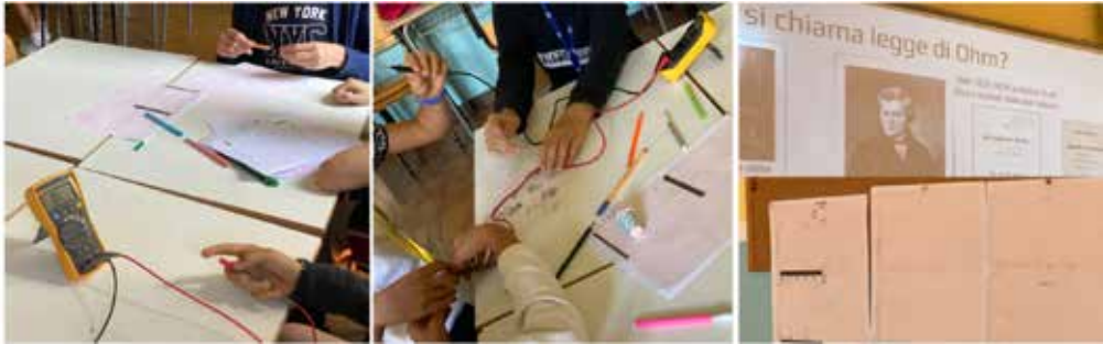
Figura 4 Misure e grafici per ricavare la II legge di Ohm
